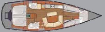
Wnętrze A - 4 kab.
